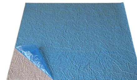
SMC - Sheet Molding Compound – полиэфирный листовой прессматериал (препрег) в виде листа, который покрывается с двух сторон специальной барьерной пленкой, в состав которой входят ненасыщенные полиэфирные смолы, наполнители, добавки и стекловолокно. Используется при изготовлении изделий, для которых основными характеристиками являются механическая прочность, высокое качество поверхности и огнестойкость.
